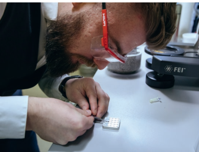
Процедура витрификации образца: подготовка (вверху) и выполнение (внизу)
